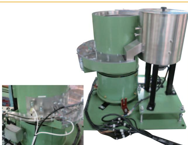
バネほぐし機でほぐした後、パーツフィーダとセットにすることで自動化システムに組み込むことができる
